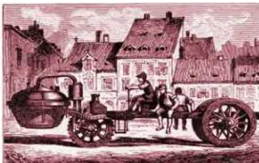
圖 1.Nicolas Joseph Cugnot所製造的蒸氣機汽車，單前輪轉向，能以 4KM/H前進。圖片來源： lieuxdits.free.fr/camion.html
